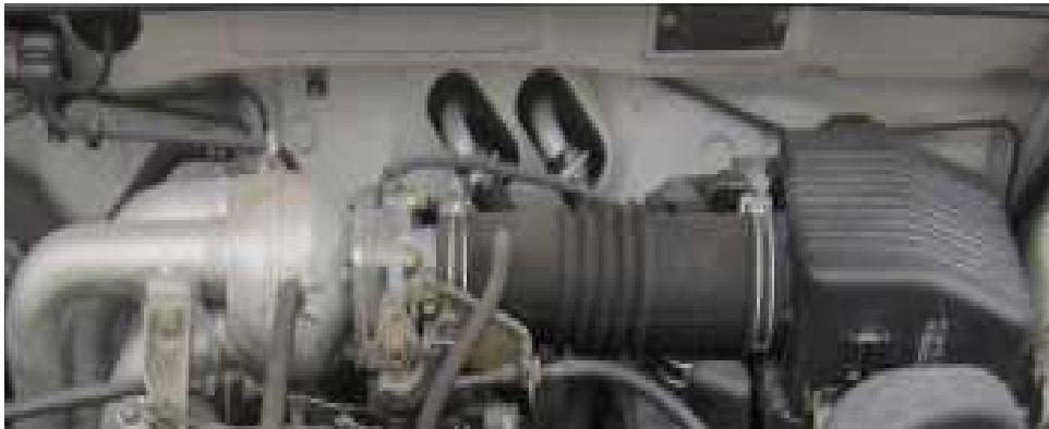
Los tubos de inducción
